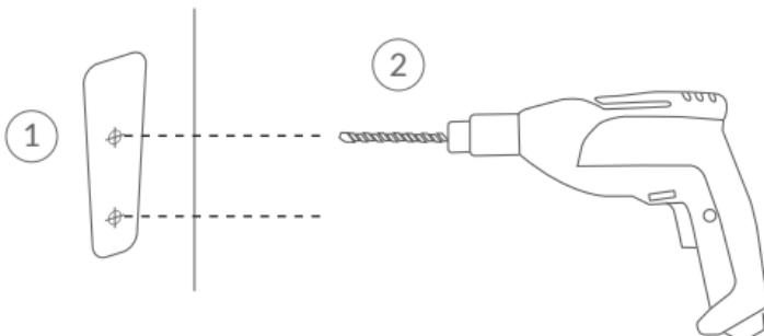
1. Bitte verwenden Sie den mitgelieferten Bohrschablone-Aufkleber, um die Bohrungspositionen auf der Wand zu markieren, anschließend bohren Sie mit einem Bohrer (6 mm) zwei Löcher.
