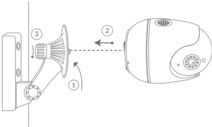
3. Stellen Sie den Winkel in die richtige Position ein, dann befestigen Sie das Orb Cam an der Halterung.
