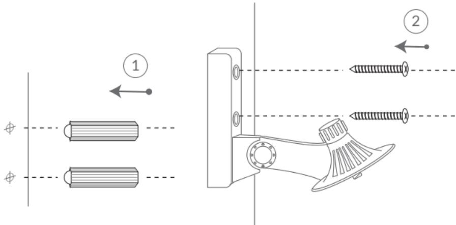
2. Installieren Sie zunächst die Anker, um die Schrauben festzuhalten, dann verwenden Sie die mitgelieferten Schrauben, um die Halterung zu installieren.
